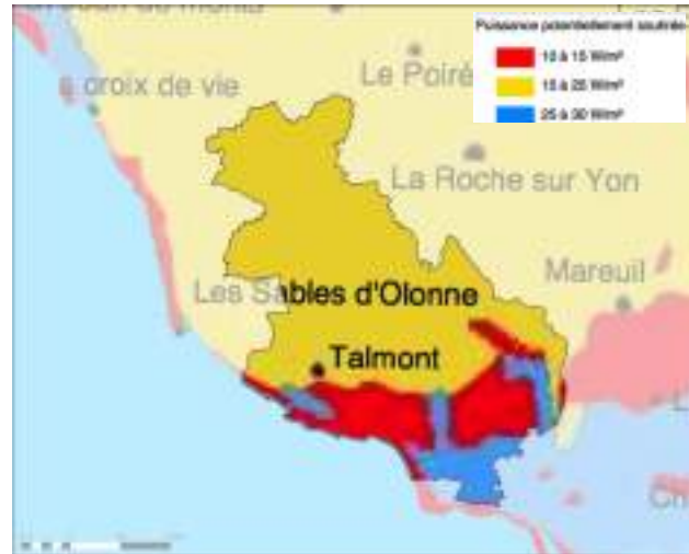
Potentiel Géothermique par sonde horizontale
