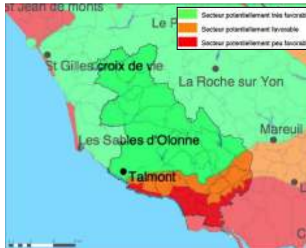
Potentiel Géothermique par sonde verticale
